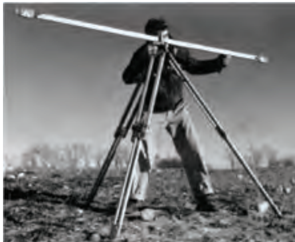
شکل ۵-۳- روش پارالاکتیک و شاخص آن
