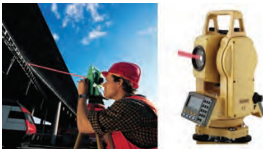
شکل ۷-۴ توتال لیزری بدون رفلکتور
