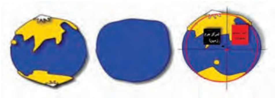
شکل ۴-۳- شکل طبیعی سطح زمین (چپ)، سطح متوسط آبهای آزاد یا ژئوئید به عنوان سطح مبنای ارتفاعی (وسط)، و بیضوی دورانی به عنوان سطح مبنای مسطحاتی (راست)
