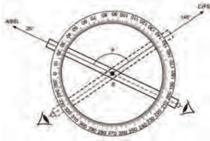
شکل ۲-۷- اندازه گیری زاویه افقی
