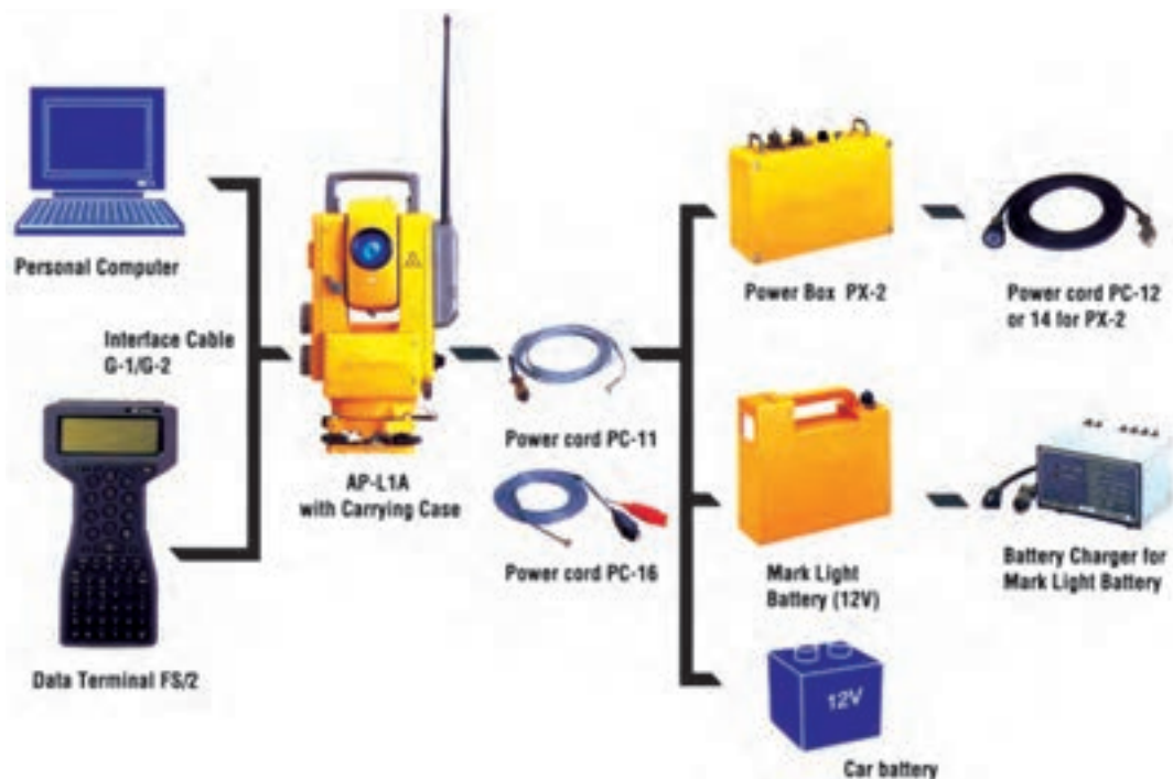
شکل ۲۲-۴ نمایش ارتباط توتال استیشن با تجهیزات جانبی
